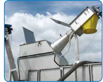
由于该设备配备有诸多观察窗, 因而便于日常维护。 Easy maintenance thanks to wide inspection hatches
